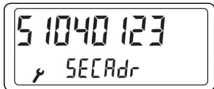
Príklad: M-Bus sekundárna adresa
