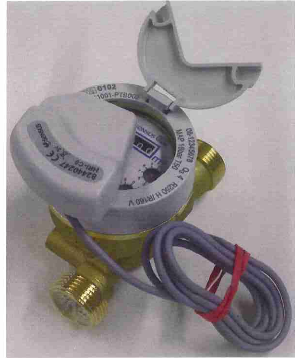
820 Q 3 4 mit Teiltrockenläufer- Zeiger- Rollenzählwerk (Rollensatz, gekapselt) (Perspektivdarstellung)
