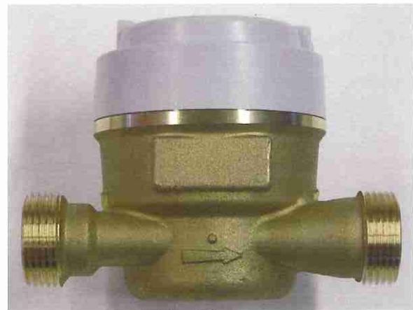
820 Q 3 4 mit Teiltrockenläufer- Zeiger- Rollenzählwerk (Rollensatz, gekapselt) (Drauf- und Seitenansicht mit Schutzdeckel ohne HRI)
