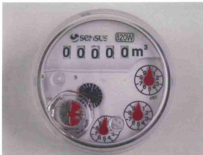
820W Q 3 4 Nassläufer- Zeiger- Rollenzählwerk aus Kunststoff
