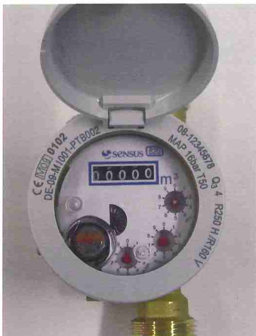
820 Q 3 4 mit Teiltrockenläufer- Zeiger- Rollenzählwerk (Rollensatz, gekapselt) (Drauf- und Seitenansicht mit Schutzdeckel ohne HRI)
