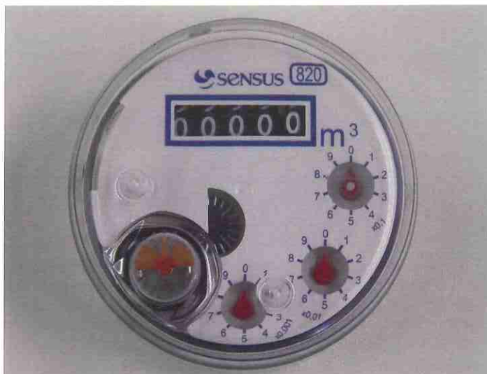
820 Q 3 4 Teiltrockenläufer- Zeiger- Rollenzählwerk aus Kunststoff (Rollensatz, gekapselt)
