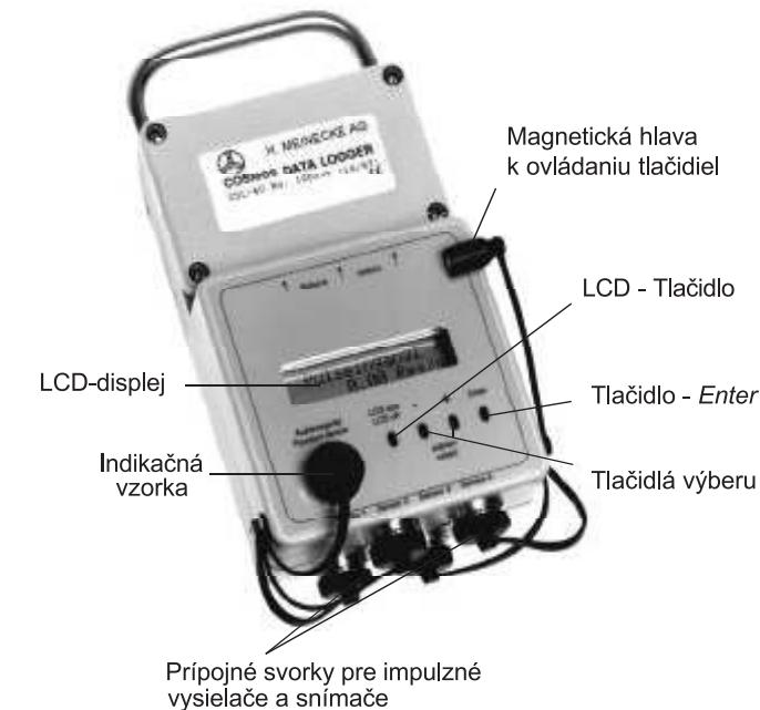
DATA - Logger je mobilná, robustná a proti vlhkosti chránená datová pamäť, ktorá zaznamenáva namerané hodnoty nezávisle od externého napájania.
