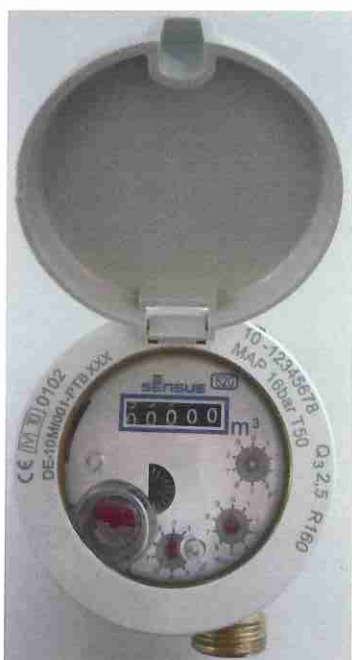
820 Q 3 2,5 mit Teiltrockenläufer- Zeiger- Rollenzählwerk (Rollensatz, gekapselt) (Drauf- und Seitenansicht mit Schutzdeckel ohne HRI)
