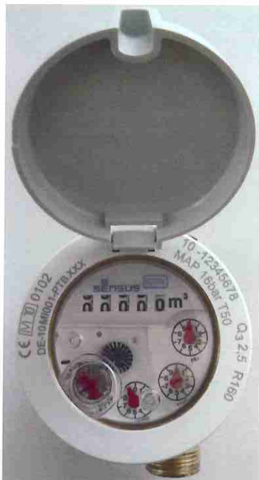
820W Q 3 2,5 mit Nassläufer- Zeiger- Rollenzählwerk (Drauf- und Seitenansicht mit Schutzdeckel ohne HRI)
